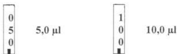
圖 3 吸取 5ml 和 10ml 時微量吸管控制面板的正確顯示
